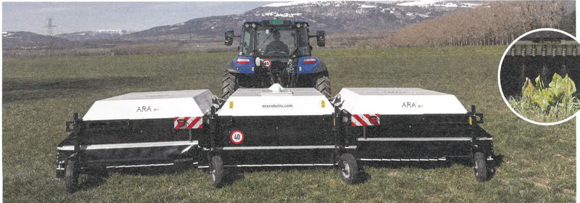
Mit 156 Düsen können das Unkraut mit selektiven oder nicht-selektiven Herbiziden oder die Nutzpflanzen mit Fungiziden oder Insektiziden behandelt werden.
