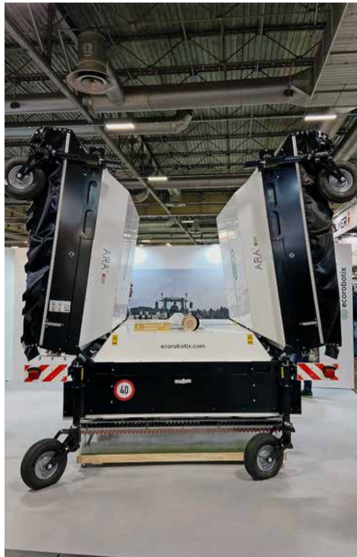
Présentation à Paris du robot en position «transport», avec les deux modules repliés. A.-X. WURST
