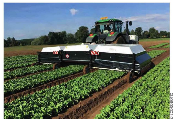
« Ecorobotix est capable de repérer et de détruire les adventices, sans aucun réglage, avec une vitesse. Grâce à des algorithmes performants, le pulvé va détruire tout ce qui est autre », atteste Rémi Laigneau.
